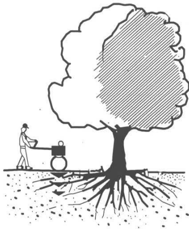
Abb. 2 und 3: Bodenverdichtungen im Wurzelbereich führen zum Absterben des Baumes (Einsatz von Baumaschinen)
